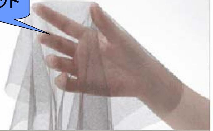
2層で使用すると10MHz～1GHzの高周波電磁波を40dB前後遮蔽
