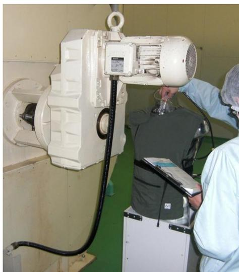
同様に次のページ写真の大型モーターも参考として測定しましたが、金属のカバーが装着されており、密着の距離でも最大値が  $18\mu\text{T}$  で ICD への電磁干渉の可能性はありませんでした。
