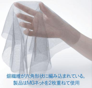
ナイロンに銀をコーティングした銀繊維13本を束ねたより糸を、網目が均一なハニカム状に編みこんだ。10cm間の電気抵抗値は1Ω前後で導電性が高く、高周波電磁波を反射する能力が高い。
