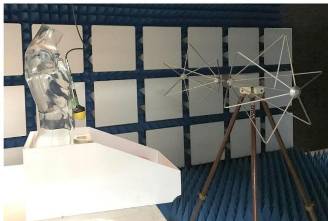
図2 電波全無響室内における人体型ファントムと送信アンテナの配置
