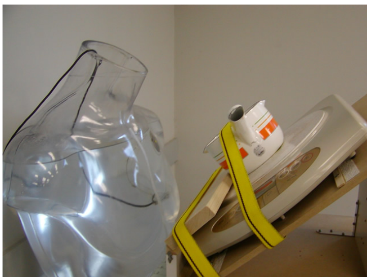
(図1)0.18%NaClで満たした人体ファントムとIH調理器の実験風景
